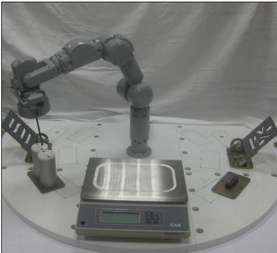
5. Разработана система силомоментного управления макетным образцом, включающая реализацию гибридного сило-скоростного управления и импедансного управления
